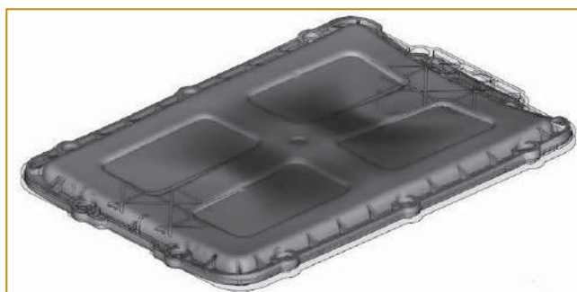
Рис. 6. Форма крышки, полученная в результате коробления
