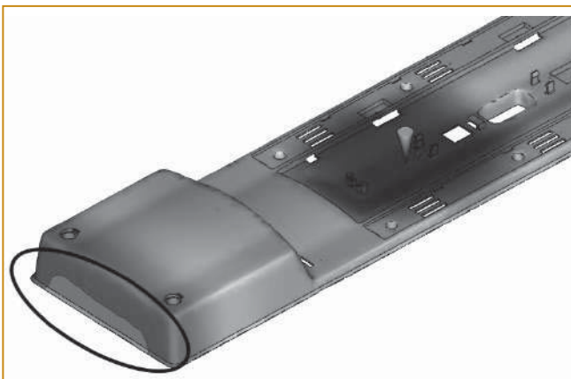
Рис. 1. Дефект при расчете с одной точкой впрыска
