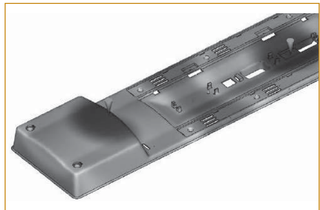
Рис. 2. Расчет с двумя точками впрыска без дефектов
