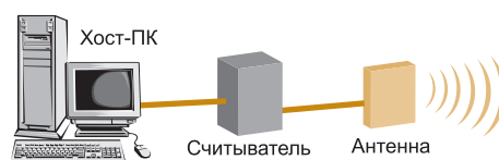
Рис. 1. Простейшая система считывания RFID: хост-ПК, считыватель и одна антенна
