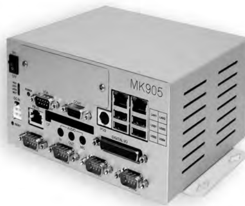
Рис. 5. Общий вид модульного компьютера MK905-01
