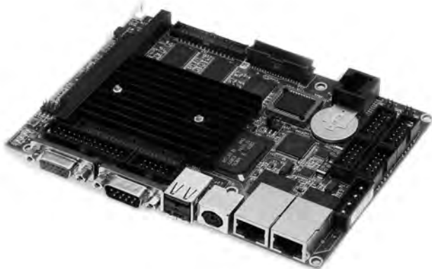
Рис. 2. Одноплатный компьютер FASTWEL CPB90204
