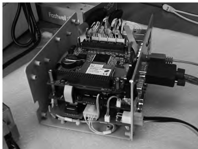
Рис. 6. Компьютер MK905 с установленной платой CNM350-01 (виден свободный слот для размещения дополнительной платы формата PC/104+)
