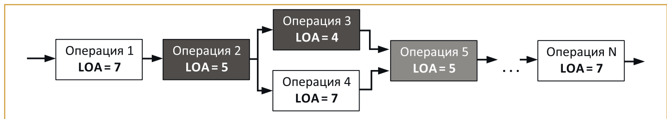
Рис. 3. Визуализация цепочек операций по уровням LOA, где операции 1, 7, N выполняются автоматически, операция 5 требует контроля со стороны человека, операции 2 и 3 требуют участия человека
