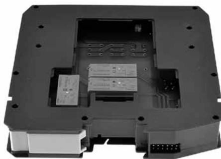
Рис. 4. Релейный модуль D5090S со снятой крышкой
