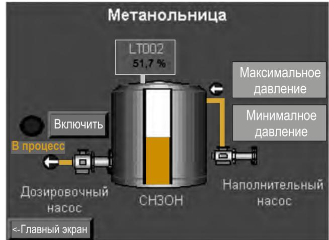
Рис. 4. Фрагмент мнемосхемы АРМа оператора
