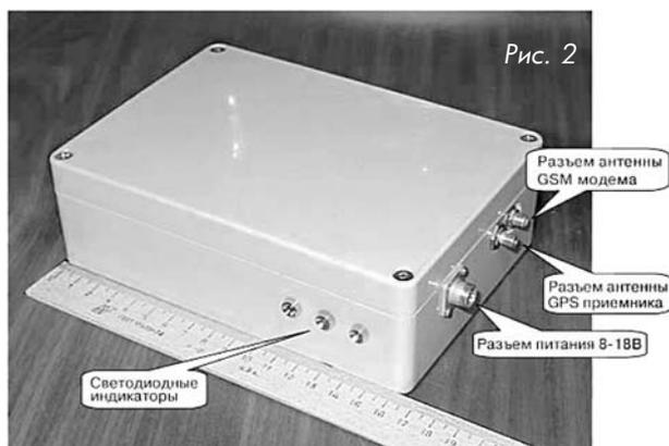
с предельным диапазоном температур хранения  $-40...85\text{ }^{\circ}\text{C}$ , диапазонная тряска 2...5 г, 5...80 Гц, технологическая тряска до 200 Гц, удары до 10 г.
