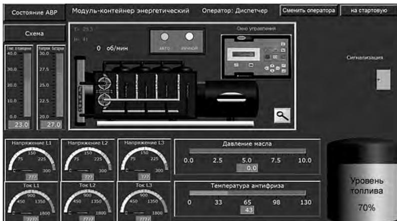
Рис. 5. Система контроля дизель-генератора в составе АСУЗ
