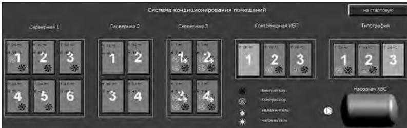
Рис. 4. Контроль кондиционеров в составе АСУЗ
