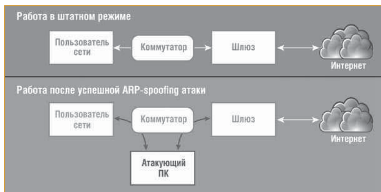
Рис. 1. Пример ARP-spoofing атаки
