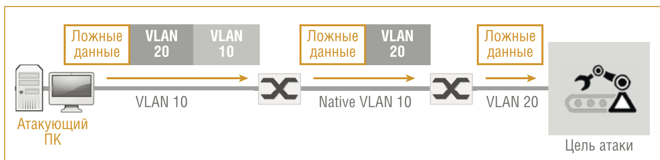
Рис. 2. Пример атаки типа VLAN hopping/Double tagging attack
