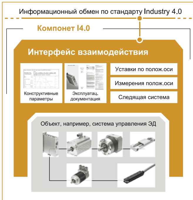
Рис. 3. Представление объекта в виде описательной структуры на примере системы управления положением оси электродвигателя [5]
