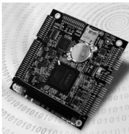
Рис. 1. Процессорная плата в формате PC/104 – VSX104
