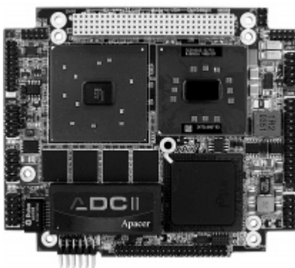
Рис. 3. Процессорная плата в стандарте PCI-104 – CMx158886
