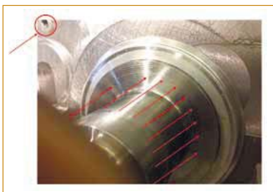
Рис. 7. Следы задевания на роторе компрессора
