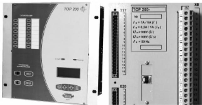
Рис. 2. Внешний вид терминала TOP200 с поддержкой стандарта МЭК 61850
