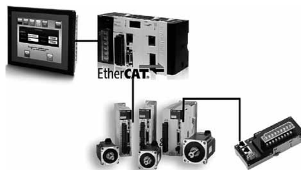
Рис. 2. Схема использования контроллера управления движением без ПЛК в системе управления металлорежущего оборудования
