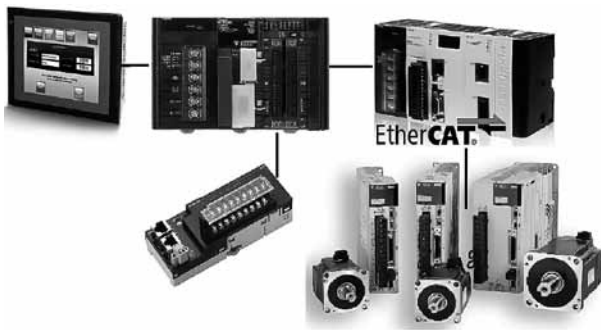
Рис. 3. Схема использования контроллера управления движением связанного с ПЛК по сетевому интерфейсу в системе управления металлорежущего оборудования
