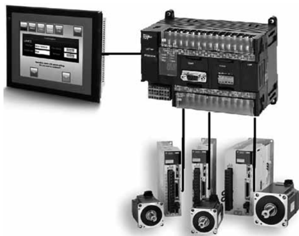
Рис. 1. Схема использования контроллера позиционирования в системе управления металлорежущего оборудования
