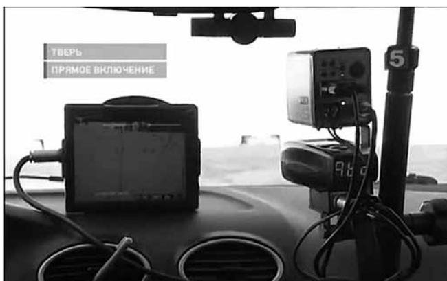
Рис. 4. Новый патрульный автомобиль ДПС с бортовым компьютером АРГУС-БК на основе fit-PC2
