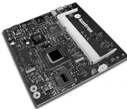
Рис. 5. Внешний вид модуля microETXexpress-SP на базе процессора серии Intel Atom Z5xx и интегрированного чипсета Intel SCH US15W
