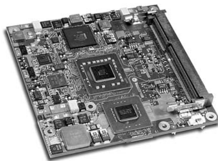
Рис. 6. Внешний вид компьютера-модуля microETXexpress-PC, несущего чипсет Intel GS45 SFF + ICH9M и поддерживающего высокопроизводительные процессоры Intel Core 2 Duo
