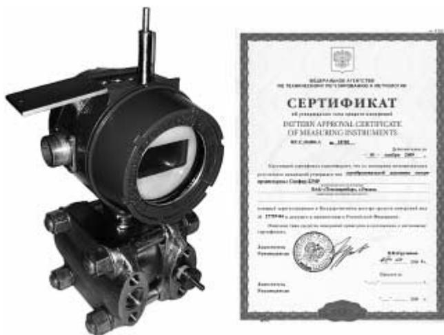
Рис. 4. Измерительный преобразователь "Сапфир-22МР"
