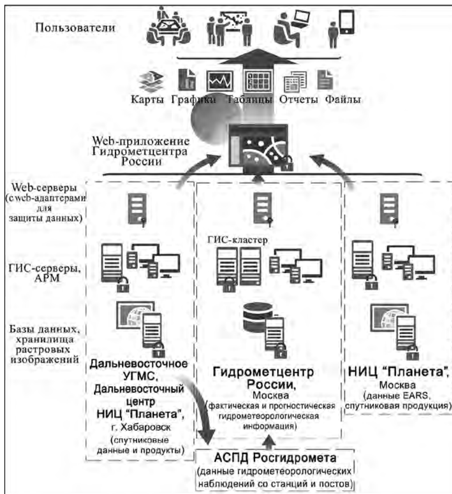
Рис. 1. Структурная схема подсистемы подготовки и доведения до потребителей выходной информации «ГИС Амур»
