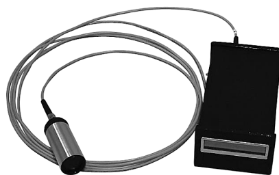
Рис. 5. Макет пирометра ПД-7 с пластиковым волокном
