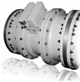
Рис. 1. НИТ, оснащенный датчиком тока и напряжения ELK-CP3
