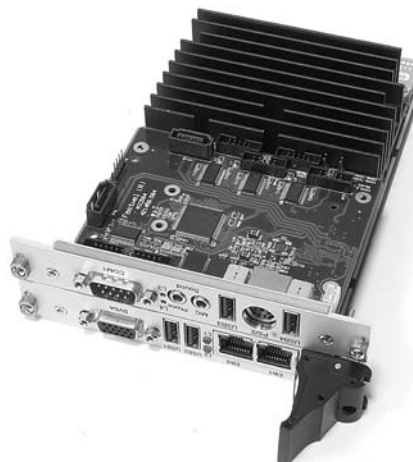
Рис. 6. Fastwel CPC506 с мезонином ввода/вывода
