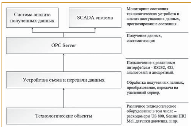
Рис. 5. Схема сбора и передачи технологической информации в системе водоснабжения
