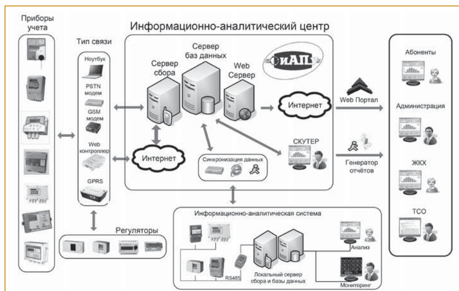
Рис. 1. Архитектура центра сбора данных с приборов учета и регулирования
