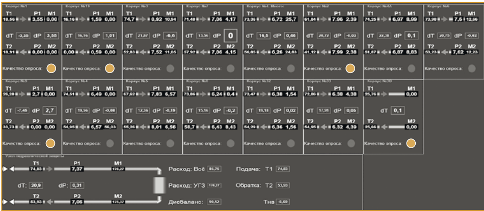
Рис. 8. Мнемосхема мониторинга тепловых узлов завода
