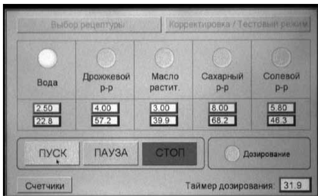
Рис.3. Главное окно оператора в режиме дозирования
