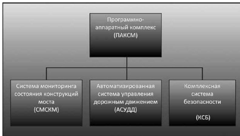
Рис. 2. Структура системы мониторинга моста на о. Русский
