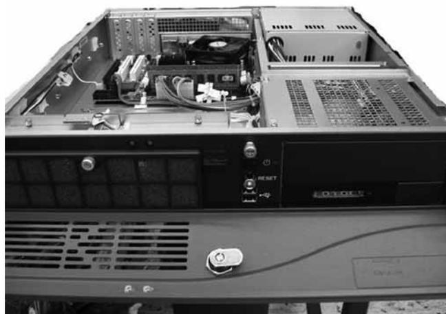
Рис. 5. Сервер KISS 2U KTQ45/Flex Low profile поддерживает установку четырех плат расширения
