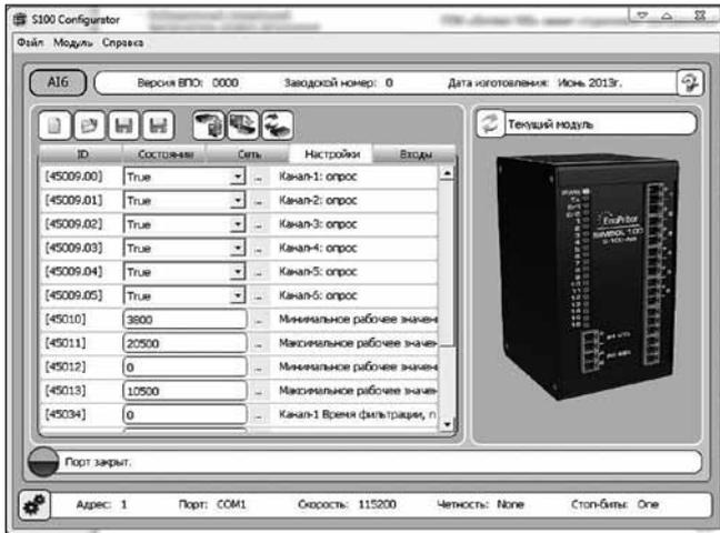
Рис. 4. Программа для конфигурирования модулей расширения S100Configurator
