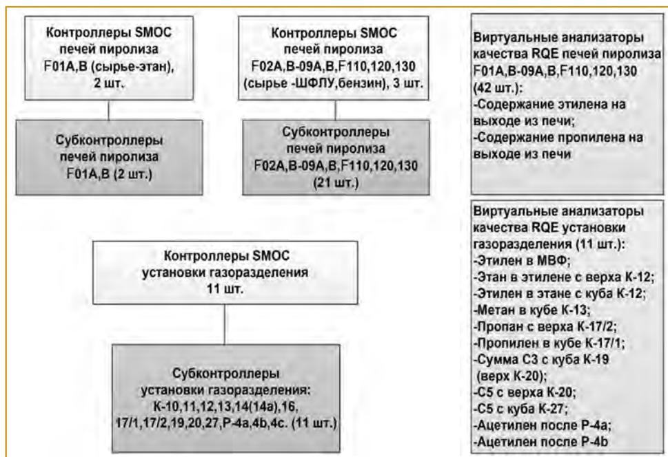
Рис. 2. Структура разработанной модели СУУТП ЭП-360
