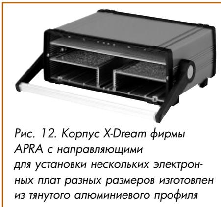
Рис. 12. Корпус X-Dream фирмы APRA с направляющими для установки нескольких электронных плат разных размеров изготовлен из тянутого алюминиевого профиля
