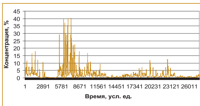
Рис. 3. Хроматограмма газового хроматографа измерение C1...C5
