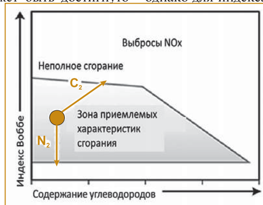
Рис. 1. Режим предварительного смешивания компонентов процесса горения
