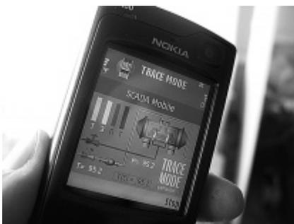
Рис. 7. Мобильный интерфейс, разработанный в SCADA-системе TRACE MODE 6 для телефона Nokia N80
