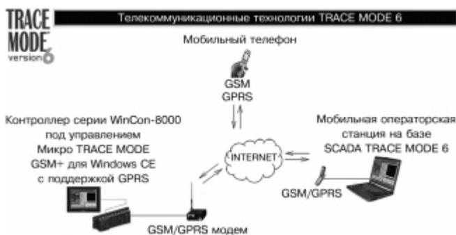
Рис. 2. Телекоммуникационная система управления на базе PAC контроллера серии WinCon-8000 под управлением Микро TRACE MODE GSM+ для Windows CE с поддержкой GPRS
