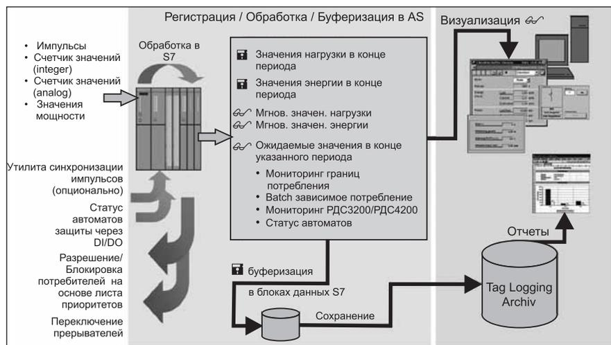
Рис. 2. Структура ПО powerrate
