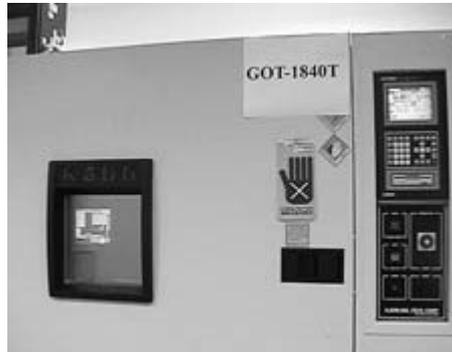
*Рис. 3. Стенд термических испытаний. В климатической камере – операторская панель GOT-1840T с сенсорным экраном. Температура 45°C, влажность 54%. Панель работает, прогоняется стандартный тест коммуникационных портов. Если за время цикла испытаний ОС WinCE.NET хоть раз "зависнет", панель спишут в брак*
