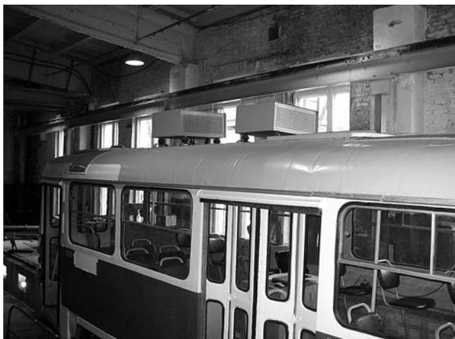
Рис. 3. Размещение тормозных резисторов
