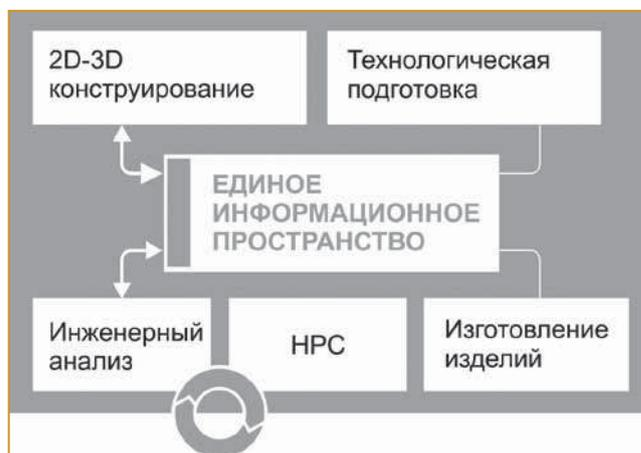
Рис. 1. Этапы бизнес-процесса параллельной конструкторско-технологической подготовки производства
