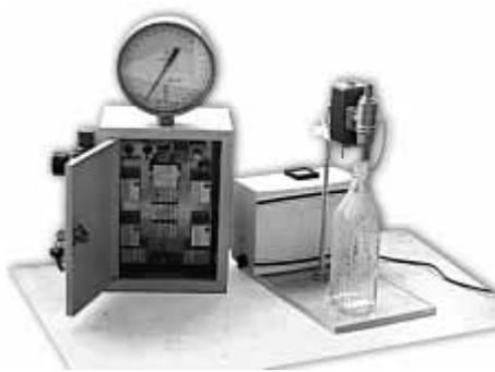
Рис. 3б. Внешний вид электропневматической САД с отмериванием дозы по времени
