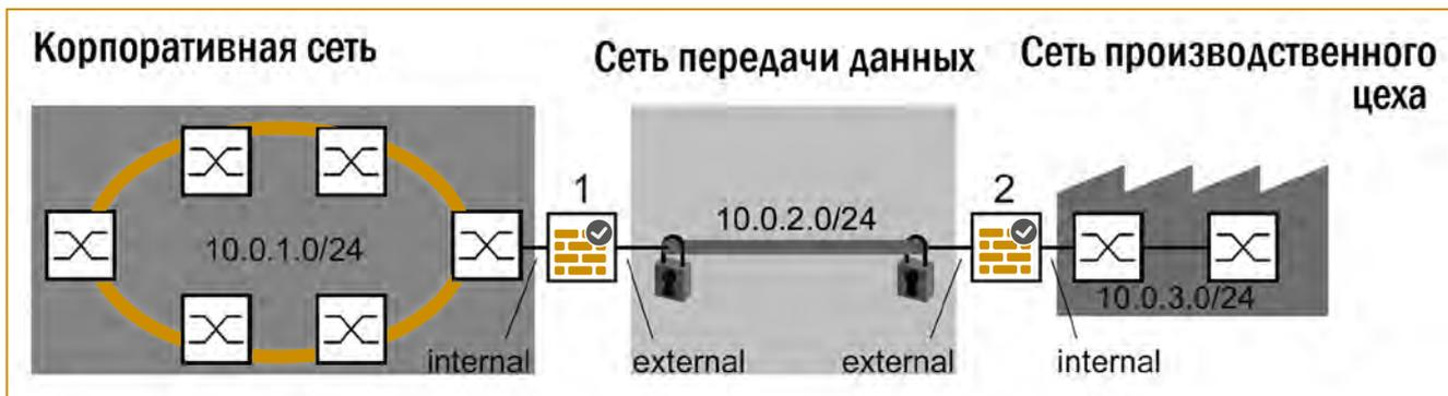
Рис. 6. Защищенное соединение при помощи создания VPN-туннеля
