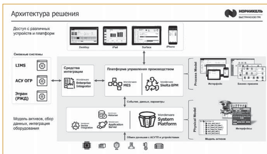
Рис. 2. Архитектура системы автоматизации
