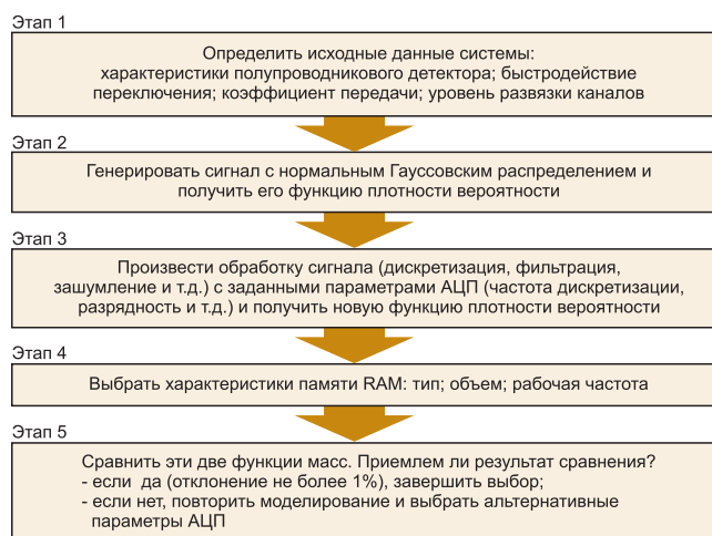
Рис. 2. Методика выбора цифрового сигнального микроконтроллера
