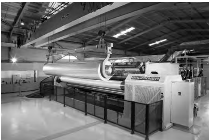
Рис. 1. Двухкоординатная машина для растяжения пленки
