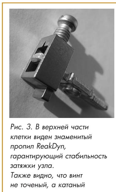
Рис. 3. В верхней части клетки виден знаменитый пропил ReakDyn, гарантирующий стабильность затяжки узла. Также видно, что винт не точеный, а катаный
