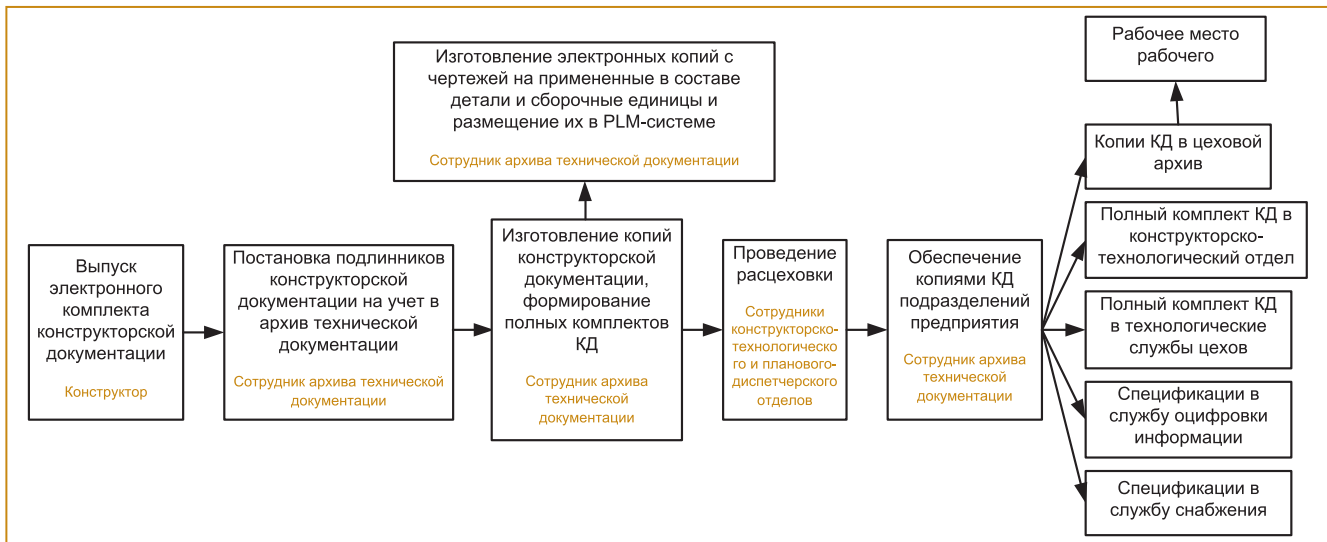
Рис. 1. Традиционная модель обеспечения чертежами рабочего места исполнителя технологических операций
