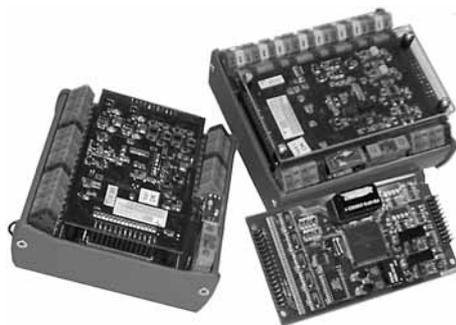
Рис. 2. Контроллеры распределенного ввода сигналов температурных датчиков MIRage-FPT и MIRage-FTHERM
