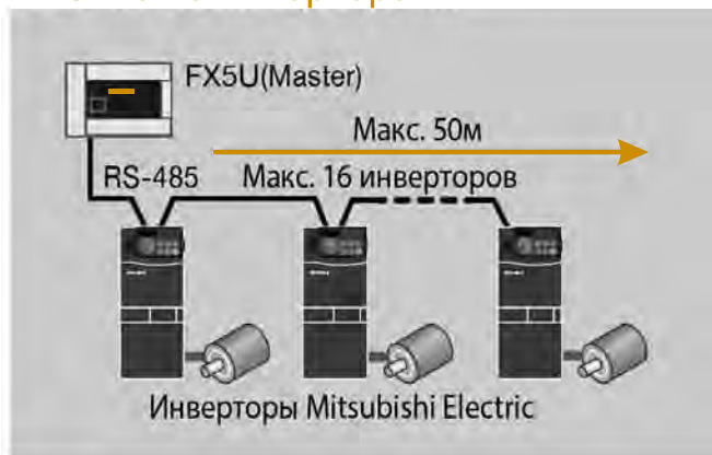
Рис. 3. Использование интерфейса RS-485
