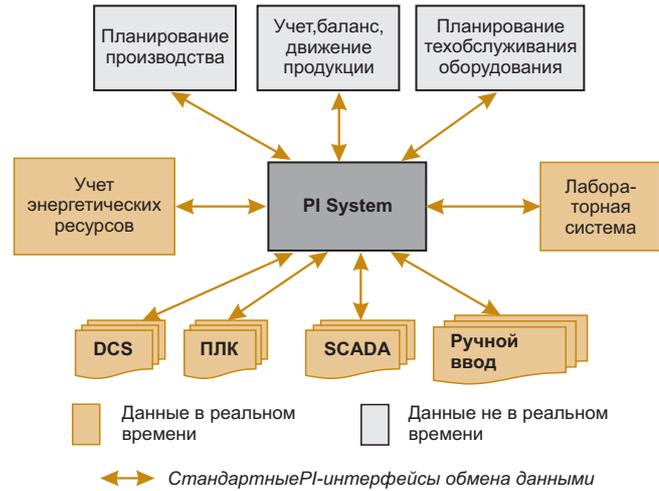
Рис. 3. Структура вертикально интегрированной системы на базе PI System.
