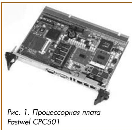
Рис. 1. Процессорная плата Fastwel CPC501
