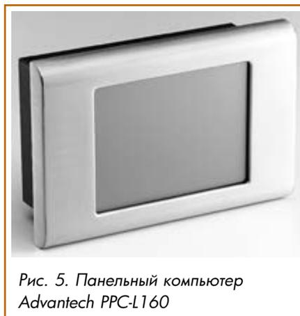
Рис. 5. Панельный компьютер Advantech PPC-L160
