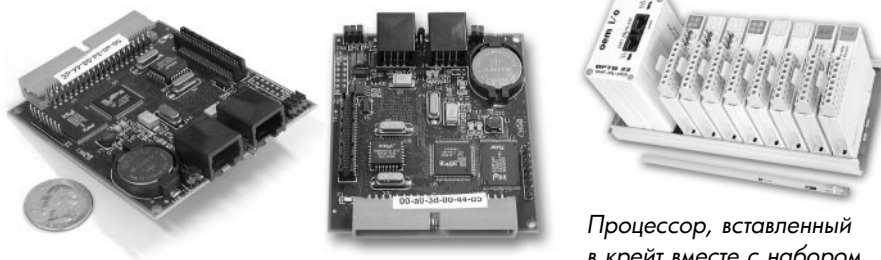
Рис. 2. "Голая" плата процессора без корпуса. Разъем внизу вставляется в крейт для подключения питания и доступа к каналам ввода/вывода
