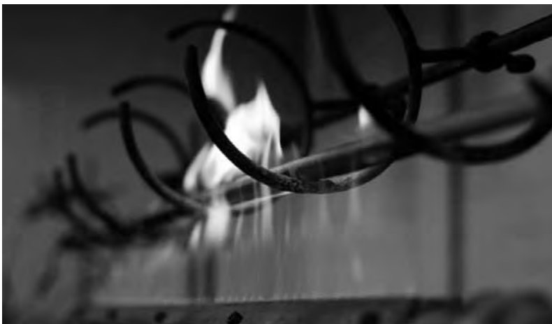
Рис. 1. Испытания кабелей СПЕЦПЛАН® на огнестойкость
