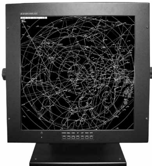
Рис. 1. Монитор Aydin 30281 — разрешение 2048x2048 пикселей, LCD TFT монитор для отображения информации с радиолокатора (одна из задач управления воздушным движением)
