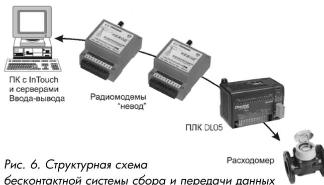
Рис. 6. Структурная схема бесконтактной системы сбора и передачи данных
