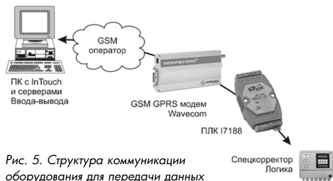
Рис. 5. Структура коммуникации оборудования для передачи данных
