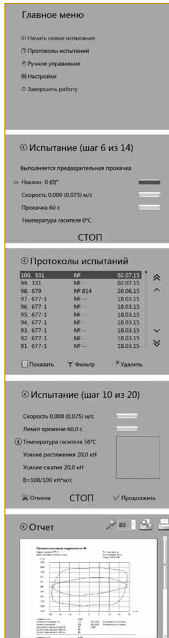
Рис. 2. Интерфейс управляющей программы и протокол испытания демпфера
