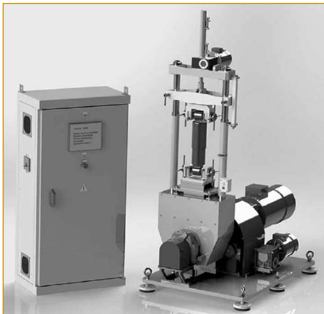
Рис. 1. Стенд для испытания гидравлических гасителей колебаний тягового подвижного состава А3124
